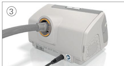
3 Conecte a tubulação de ar firmemente à saída de ar localizada na parte posterior do dispositivo.
