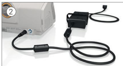
2 Conecte o conector de energia na parte posterior do dispositivo. Conecte uma extremidade do cabo de alimentação à unidade de alimentação e a outra extremidade à tomada de energia.
